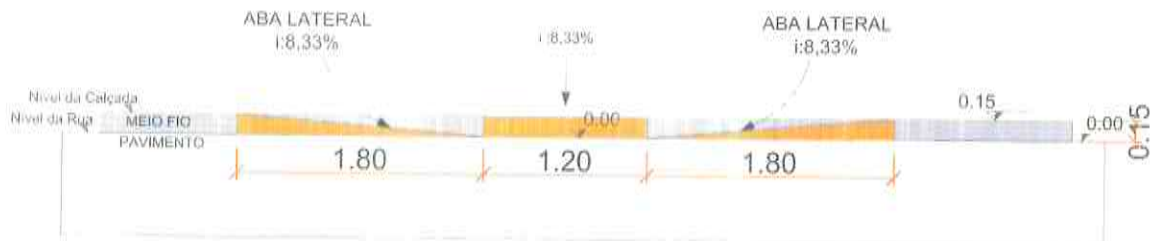
ELEVÇÃO DA RAMPA DE ACESSIBILIDADE SEM ESCALA
